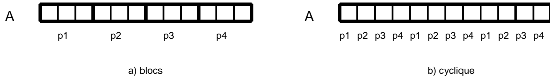
FIG. 2.1 – Schéma d'une distribution en blocs a) et d'une distribution cyclique b) des données sur 4 processeurs (p1,p2,p3 et p4)
